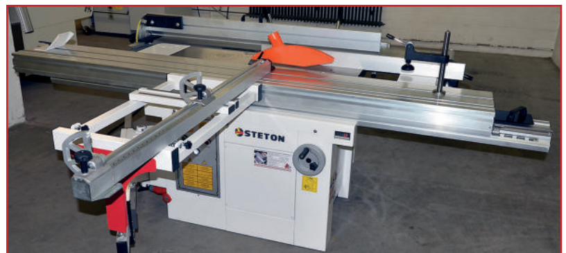
STETON 5 fach kombinierte, CH400 X5 kurz und lang Version, Formatkreissäge, Abricht-/Dickenhobelmaschine, Tischfräse, Bohreinheit, Neumaschine, CE-Zeichen, weitere technische Daten und Modelle siehe Seite 54
