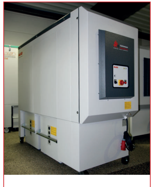
AL-KO Power Unit APU 200 P, Neumaschine, CE-Zeichen, schallgedämpft 72dB, Motor 400Volt - 3kW, Ansaugstutzen \varnothing = 200\text{mm} , Vorabscheidung zur Filterschonung, 2 fahrbare Abscheidecontainer je 241ltr. mit Staubschott, pneumatisch gesteuerte Filterabreinigung (über SPS), Abmessungen: L= 2.296mm, B= 830mm, H= 2.050mm, Gewicht 460kg, max. Volumenstrom 3.010m 3 /h, max. Unterdruck 2.563Pa, Maschine pulverbeschichtet, Bild rechts
