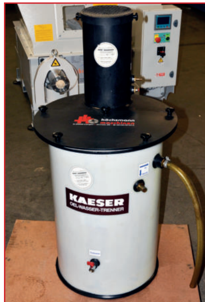
KAESER Öl Wasser Trenngerät ÖWAMAT KWO 3, Behälterdurchmesser ca. 600mm, Gesamthöhe ca. 1200mm, mit Aktivkohlefilter, Platzbedarf ca. Ø 700x1200mm Eigengewicht ca. 30kg, für max. Kompressorleistung 15.000l/min, Kondensatdurchsatz max. 50l / Stunde, guter Zustand
