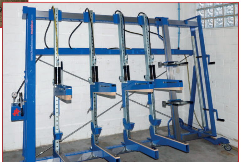
BECK Verleimständer, 3 Niederhalter, Spannmaße: 720 mm, Stellmaß: 400x1.050x 1.100mm, guter Zustand, Bild links
