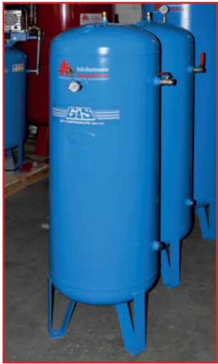
GIS Druckluft Kessel vertikal 270, Neu, CE Zeichen, Volumen 270ltr. max. 11bar, komplett mit Kugelhähnen, Anschlussteilen und Manometer, auf Wunsch mit automatischer Entwässerung (Aufpreis), Maße: Höhe 1.660mm x Ø490mm, Bild links
