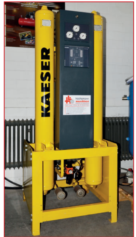
KAESER Adsorptionstrockner, DC18E Sigma-dry, Baujahr 2010, CE Zeichen, Vorführmaschine, kalt regenerierender Adsorptionstrockner mit vor- und nachgeschaltetem Feinstfiltern für Drucktaupunkte bis -70°, Volumenstrom 1,83m³/min, max. 16 bar, 2x35l Auffangbehälter, automatische Taupunktsteuerung ECO-Control, Gewicht 220kg, Maße 750x750x1.950mm (BxTxH)
