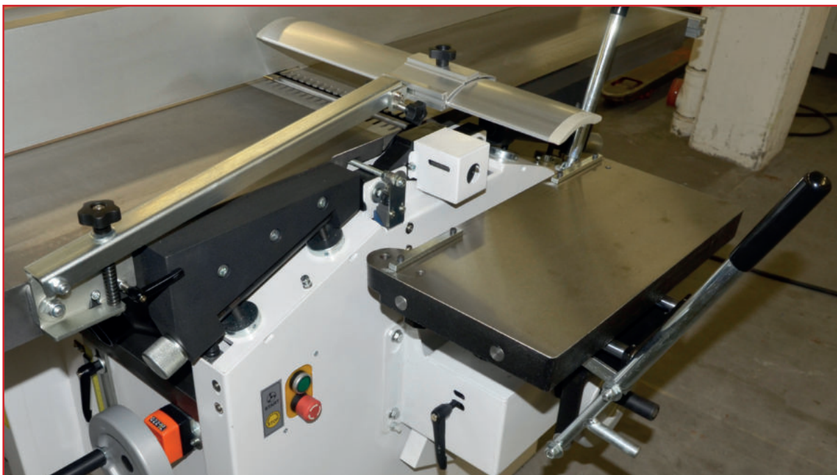
STETON 5 fach kombinierte, CH 400 X5 lang, Formatkreissäge, Abricht-/Dickenhobelmaschine, Tischfräse, Bohreinheit, Neumaschine, CE-Zei., Formatkreissäge: Besäumlänge 2.600 mm, weitere Daten wie CH400 X5 kurz
