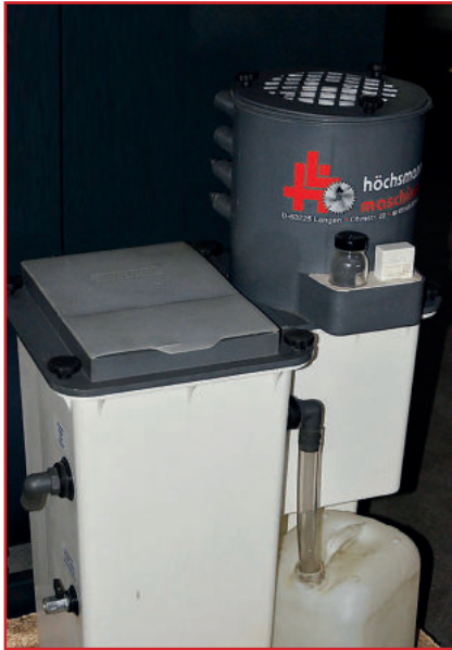
Öl Wasser Trenngerät, mit Aktivkohlefilter, Platzbedarf LxBxH 600x380x950mm, guter Zustand, Bild links
