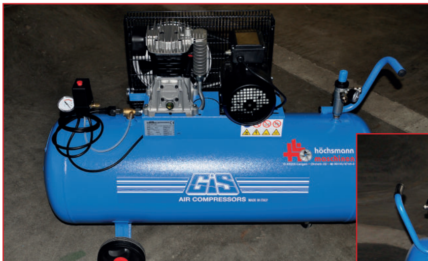
GIS GS 17 / 150 / 320 / Car, Neumaschine, CE-Zeichen, maximaler Volumenstrom ca. 320ltr./min, mit 150ltr. Kessel, Motor 400V / 2,2kW, ruhiger geräuscharmer Lauf (nur 78db/A), Abmessungen 1.200x880x400mm, Gewicht 78kg
