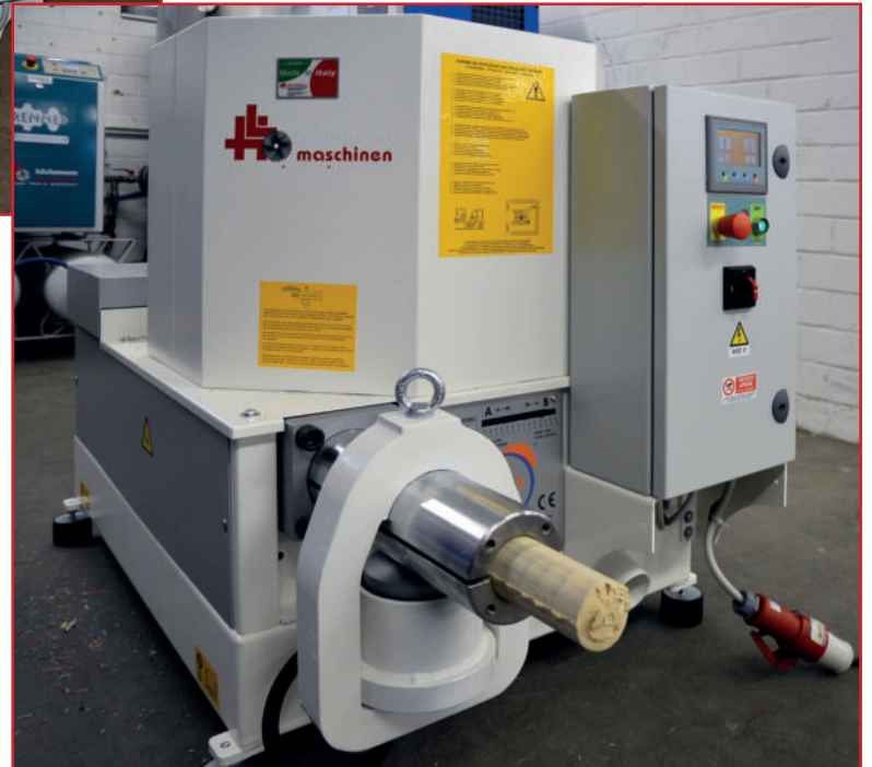
PRODECO Brikettpresse E 60 Nano , vorführbereite Ausstellungsmaschine, CE-Zeichen, mit Spänebehälter, hydraulisches System 5,5kW, Brikett Ø= 60mm, Leistung 15-70kg/h, Druckkraft ca. 900kg/cm 2 , Steuerpult mit SPS Steuerung und digitalem Touch Screen Display, Serviceluke, achteckiger Behälter Ø 750mm, Maße: Höhe 1.065mm, Länge 1.500mm, Tiefe 900mm, Gewicht 450kg, Bild unten
