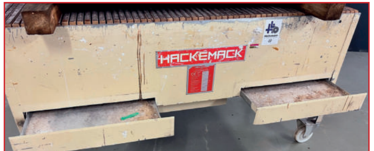
HACKEMACK, Schleifstaubabsaugtisch Typ 4540, Auflagemaß ca. 980 x 2.000 mm
