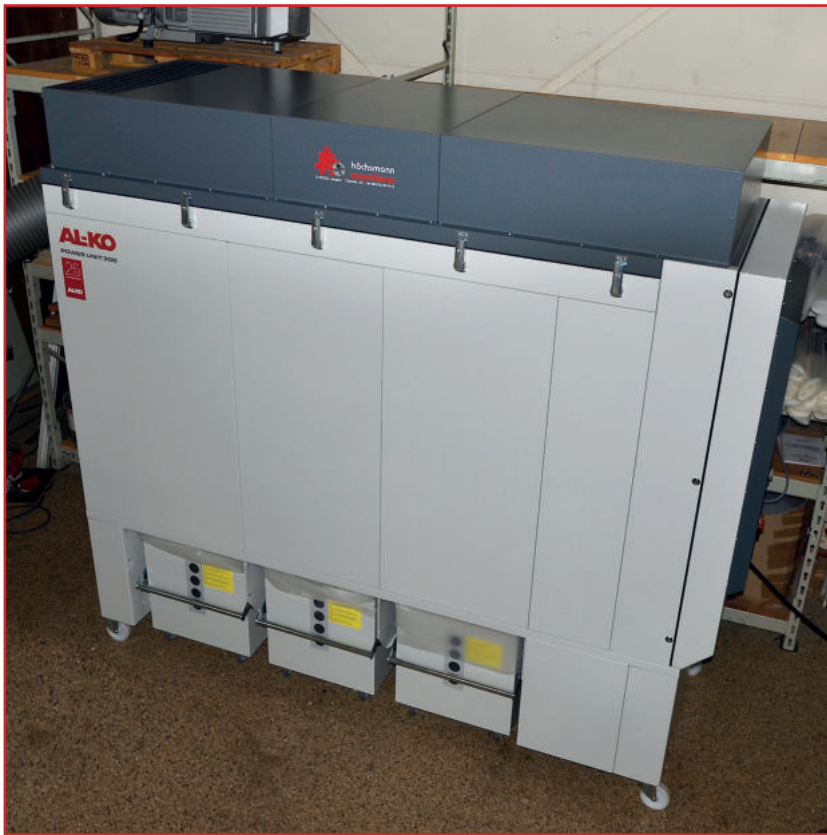
AL-KO Mobil Power Unit APU 300 P FU Silent, Neumaschine, CE-Zeichen, schallgedämpft 65dB, mit Kulissenschalldämpfer (größere Höhe beachten), Ansaugstutzen \varnothing = 300\text{mm} , drehzahlgesteuerter Motor 400Volt - 7,5kW mit Inverter, Vorabscheidung zur Filterschonung, 3 fahrbare Abscheidecontainer je 250ltr. mit Staubschott, pneumatisch gesteuerte Filterabreinigung (über SPS), Abmessungen: L= 3.000mm, B= 1.058 mm, H= 2.898mm, Gewicht ~ 958 g, max. Volumenstrom 6.000m 3 /h, max. Unterdruck 3.640Pa, Maschine pulverbeschichtet, Bild links oben
