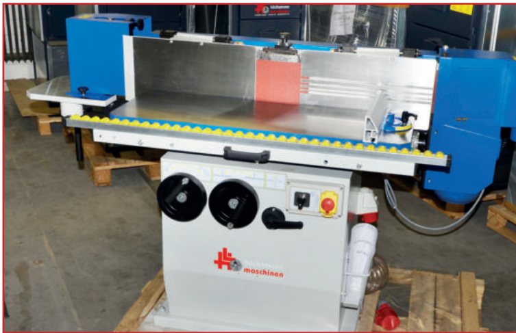
Kantenschleifmaschine WJ-KS30, Neumaschine, CE Zeichen, Arbeitstisch 960x350mm, Tischhöhenverstellung 230mm, Bandlänge 3.000mm, Bandbreite 150mm, Schleifbandrückwand 1.050x200mm, Schleifaggregat schwenkbar 90°-45°, Bandgeschwindigkeit 20m/sek., Oszillationshub 20mm, Oszillationsmotor 0,25kW, Absauganschluss Ø 120mm, Motor 3,0kW, Spannung 400V, Gewicht ca.400kg, Maschinenabmessung ca. (BxTxH) 1.910x840x1.020mm,
