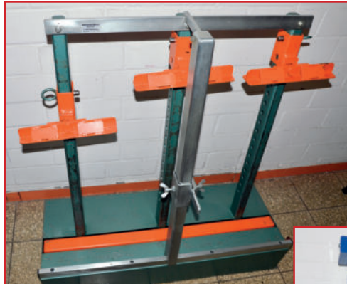
BECK Verleimständer, 3 Niederhalter, Spannmaße: 720 mm, Stellmaß: 400x1.050x 1.100mm, guter Zustand, Bild links
