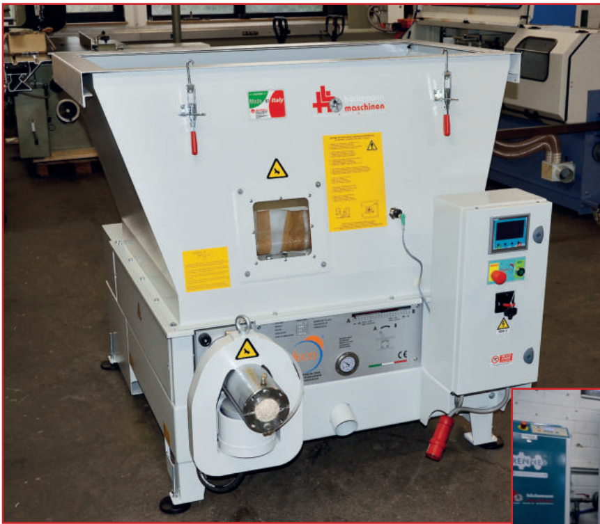
PRODECO Brikettpresse E 60 Nano Super , Neumaschine, CE-Zeichen, mit Spänebehälter, auch unterbaubar für Absauganlagen, hydraulisches System 7,5kW, Leistung 40-100kg/h, Druckkraft ca. 900kg/cm 2 , Brikett Ø= 60mm, Steuerpult mit SPS Steuerung und digitalem TouchScreen Display, Serviceluke, Höhe 1.510mm, Länge 1.850mm, Tiefe 1.170mm, Gewicht 770kg, Bild oben links
