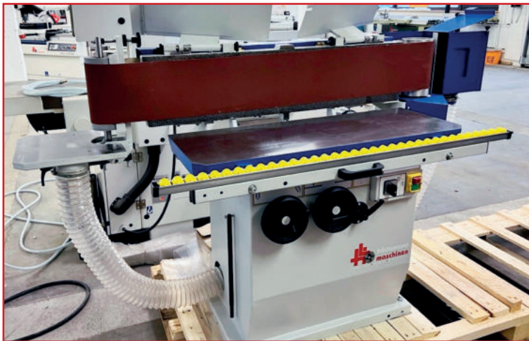
Kantenschleifmaschine WJ-KS30S, mit 200mm Bandbreite, Details WJ-KS30
