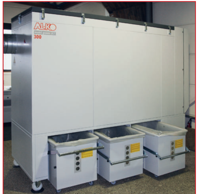
AL-KO Mobil Power Unit APU 300 P, Neumaschine, CE-Zeichen, Anlage schallgedämpft 71dB, Motor 400Volt - 7,5kW, Ansaugstutzen \varnothing = 300\text{mm} , Vorabscheidung zur Filterschonung, 3 fahrbare Abscheidecontainer je 250ltr. mit Staubschott, pneumatisch gesteuerte Filterabreinigung (über SPS), Abmessungen: L= 3.000mm, B= 1.058mm, H= 2.361mm, Gewicht 838kg, max. Volumenstrom 6.000m 3 /h, max. Unterdruck 3.434Pa, Maschine pulverbeschichtet, Bild rechts oben
