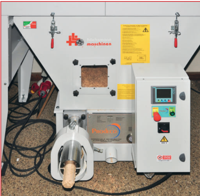
PRODECO Brikettpresse E 55 Nano , vorführbereite Ausstellungsmaschine, CE-Zeichen, hydraulisches System 4kW, Brikett Ø= 55mm, Leistung 15-60kg/h, Druckkraft ca. 850 kg/cm 2 , Steuerpult mit SPS Steuerung und digitalem Touch Screen Display, achteckig Behälter Ø 750mm, Serviceluke mit Fenster, Gewicht 450kg, Maße: Höhe 1.065mm, Länge 1.500mm, Tiefe 900mm, neuer Topzustand, Bild unten
