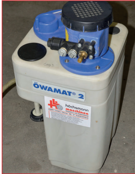
BOGE Öl / Wasser Trenngerät Öwamat 2, vollautomatisch arbeitender Öl- Wasser- Trenner für die Aufbereitung von ölhaltigem, nicht emulgiertem Druckluftkondensat, Volumenstrom bei Kolbenkompressoren max. 1,3m 3 /min bei Schraubenkompressoren max.2,2m 3 /min, Behälterinhalt ca. 55 Liter, Behälterfüllvolumen 40 Liter, Vorfilter 1x2 Liter, Aktivkohlefilter 1x3 Liter, Platzbedarf HxBxT 760x445x390mm, Leergewicht ca. 10kg, Bild oben Mitte
